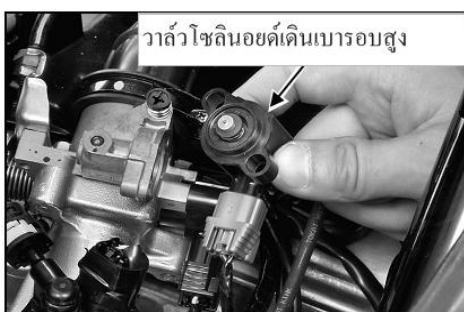
ภาพประกอบ 26 ตรวจสอบการทำงานของวาล์วโซลินอยด์เดินเบารอบสูง
