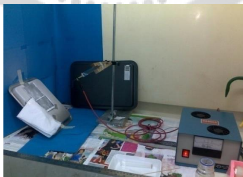
ภาพประกอบ 13 แสดงอุปกรณ์สำหรับกระบวนการปั่นด้วยไฟฟ้าสถิตที่ใช้ในงานวิจัย
