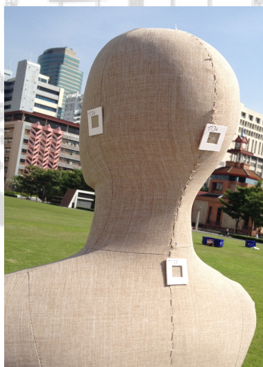
ภาพประกอบ 6 แสดงการติดแผ่นฟิล์ม Polysulfone film badges ในหุ่นทดลองด้านหลัง
