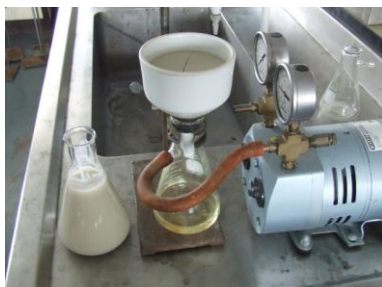
2. กรองมอนต์มอริลโลไนต์ เค 10 ด้วยเครื่องกรองสุญญากาศ
