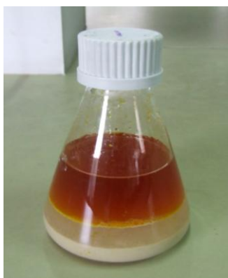
1. น้ำมันปาล์ม เฮกเซน เอนไซม์ตรีงรูป สารละลายฟอสเฟตบัพเฟอร์ ผสมเข้ากัน
