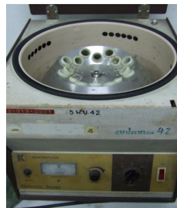
12. นำเข้าเครื่องเซนตริฟิวจ์ เพื่อแยกส่วนที่เป็นตะกอนตกค้างออกจากผลผลิต
