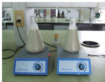
1. นำมอนต์มอริลโลไนต์ เค 10 มาล้างด้วยน้ำดีไอออนไนซ์ และ เขย่าด้วยเครื่องกวน
