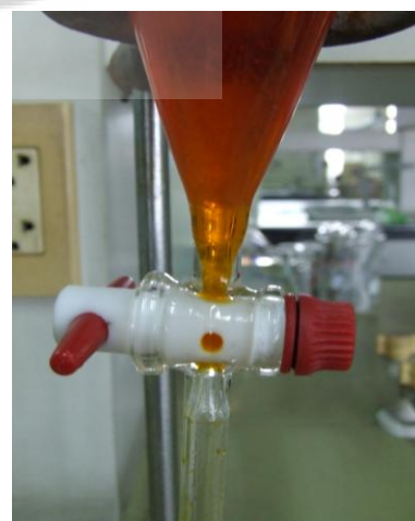
9. จะได้ผลผลิตที่คาดว่าเป็นไบโอดีเซล หลังจากแยกกลีเซอรอลชั้นล่างออก
