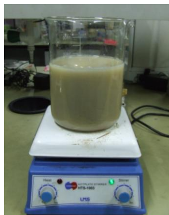
2. เมื่อผสมเสร็จแล้ว นำไปเขย่าบนเครื่องกวน
