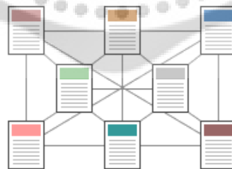
ภาพประกอบที่ 8 ภาพแสดงโครงสร้างแบบใยแมงมุม (Web Structure)
