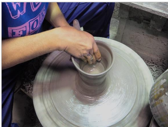
ภาพที่ 2.4 การขึ้นรูปภาชนะด้วยมือและแป้นหมุน
