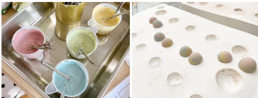
การเตรียมน้ำดินสี (ซ้าย) การเทพิมพ์และแกะพิมพ์ชิ้นงาน (ขวา)
