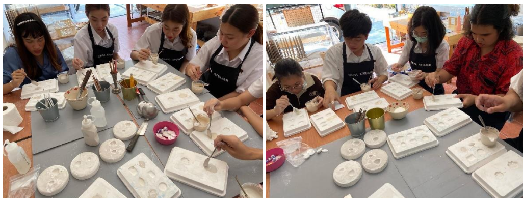
ภาพที่ 4.10 นิสิตเรียนรู้กระบวนการผลิตชิ้นรูปเซรามิกพื้นฐาน อันได้แก่ เทพิมพ์ การทำพิมพ์
