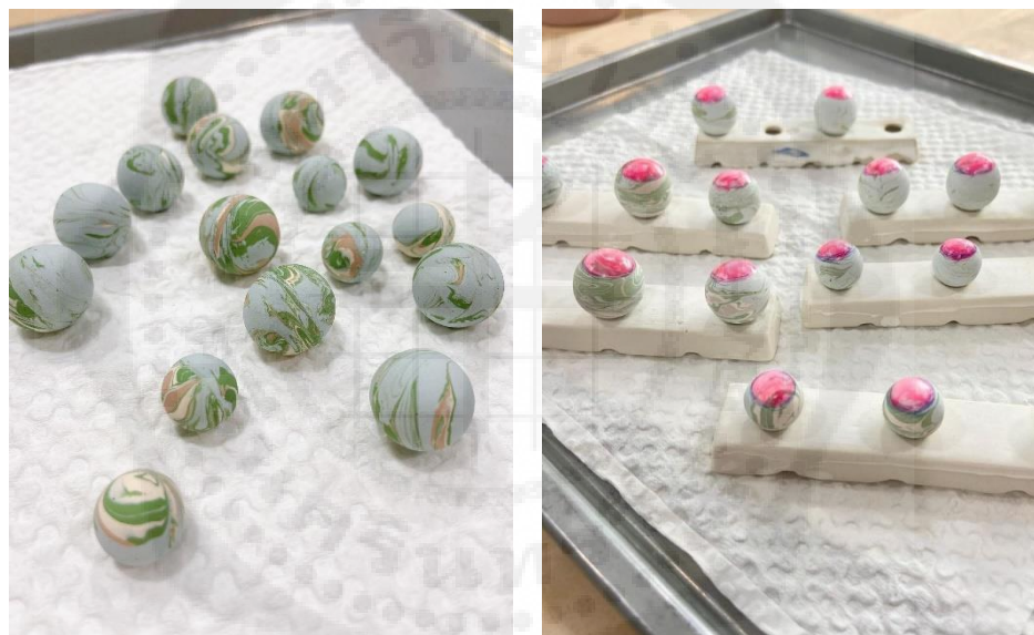
ชิ้นงานที่เผาไล่ความชื้น (ซ้าย) การเตรียมชิ้นงานเพื่อเผาเคลือบ (ขวา)
