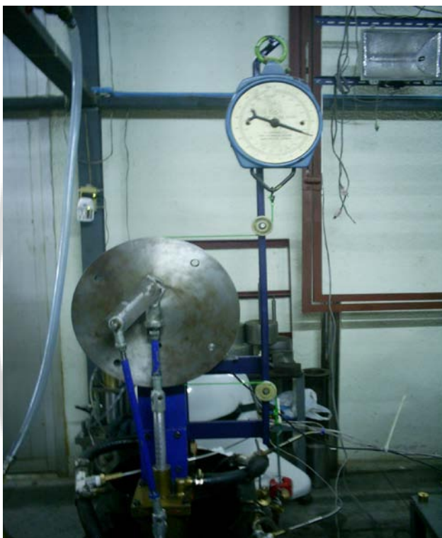
รูปที่ 3.12 ภาพถ่ายแสดงการทดสอบสมรรถนะของเครื่องยนต์
