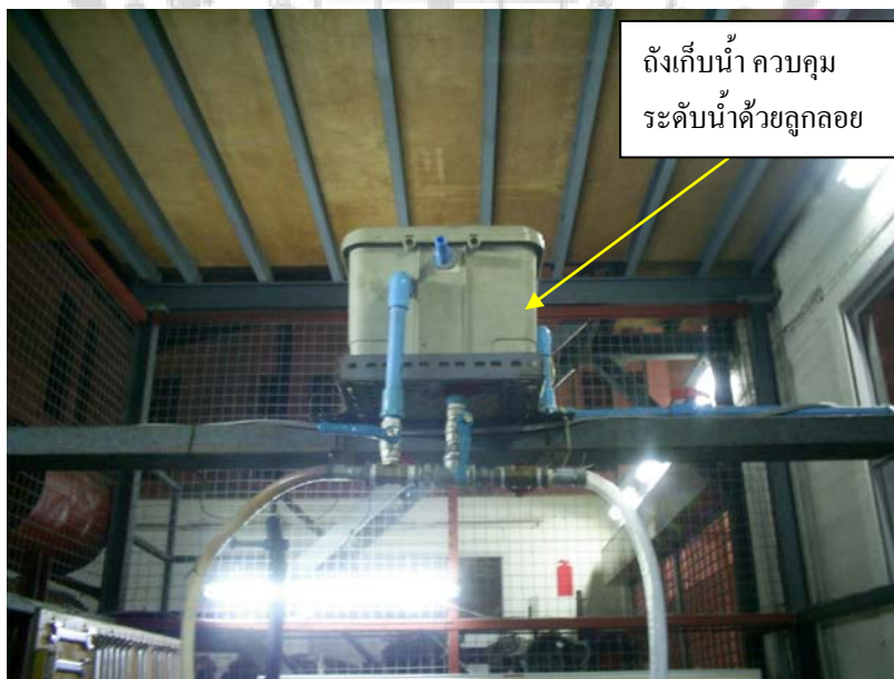
รูปที่ 3.8 ระบบน้ำระบายความร้อนของเครื่องชนิด
