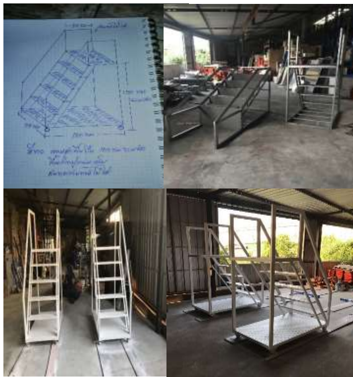
ภาพที่ 3.41 ขั้นตอนในการผลิตบันไดตื้อ
