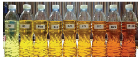
รูปที่ 6 ตัวอย่างเชื้อเพลิงอัตราส่วนผสมต่างๆ ขั้นตอนการทดลอง
