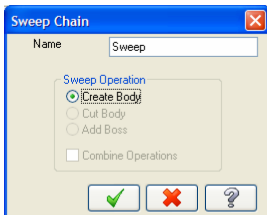
ภาพประกอบ 43 แสดงหน้าต่างสำหรับการกำหนดเงื่อนไขว่าจะเป็นการสร้างเนื้อชิ้นงาน หรือการตัดหรือการรวมเป็นเนื้อเดียวกัน
