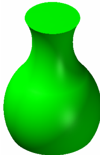
ภาพประกอบ 40 แสดงชิ้นงานที่ผ่านการใช้คำสั่ง Revolve
