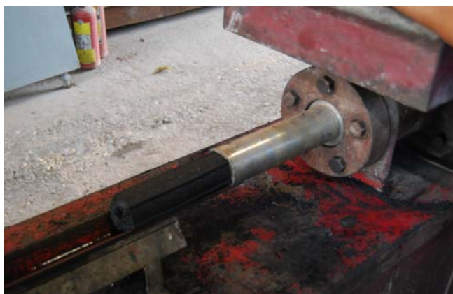
ภาพประกอบ 14 การอัดเป็นแท่งตามรูปทรงที่กำหนด
