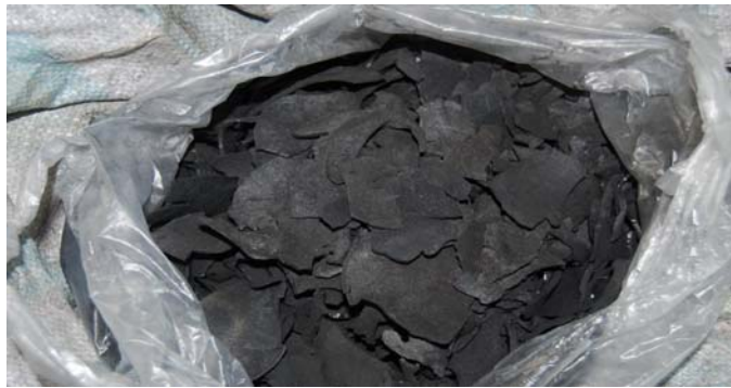
ภาพประกอบ 10 ลักษณะของถ่านที่ได้จากการเผากะลามะพร้าว
