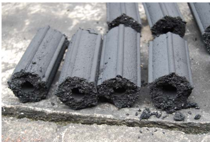
ภาพประกอบ 5 ถ่านอัดแท่งจากเหง้ามันสำปะหลัง
