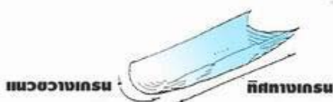
ภาพประกอบ 11 การตรวจสอบทิศทางของเส้นใยโดยดูการโค้งงอของกระดาษ
