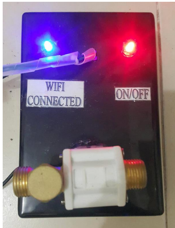
รูปที่ 4.19 แสดงวงจรขณะควบคุม SOLENOID VALVE ขณะเปิดวงจร
