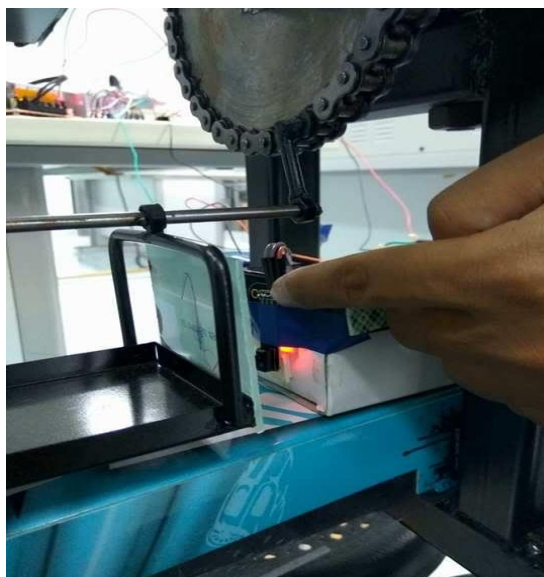
รูปที่ 4.3 การทดสอบการตรวจจับกระเช้าของเซนเซอร์
