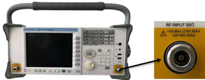
รูปที่ 4.30 ลักษณะของเครื่องวิเคราะห์ความถี่ และขีดจำกัดในการรับพลังงาน
