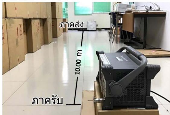
รูปที่ 4.12 การจัดวางอุปกรณ์เพื่อวัดกำลังงานโดยผ่านทางสายอากาศส่งและรับ
