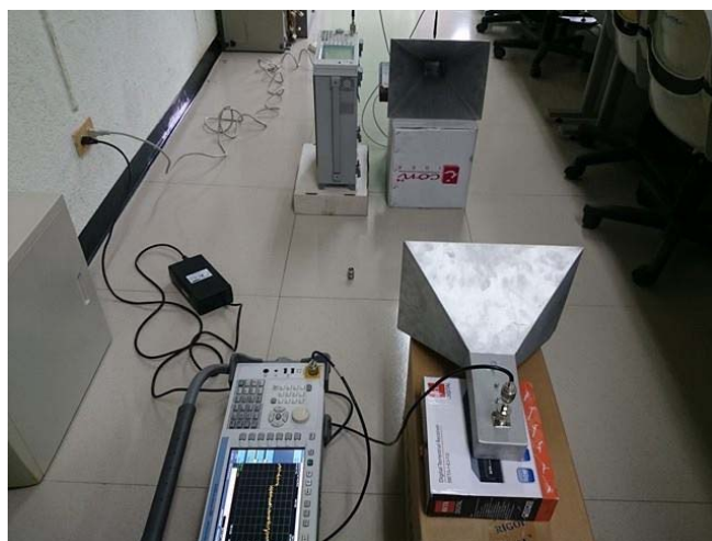
รูปที่ 4.31 การวัดกำลังงานที่ภาครับกรณีใช้สายอากาศโมโนโพล
