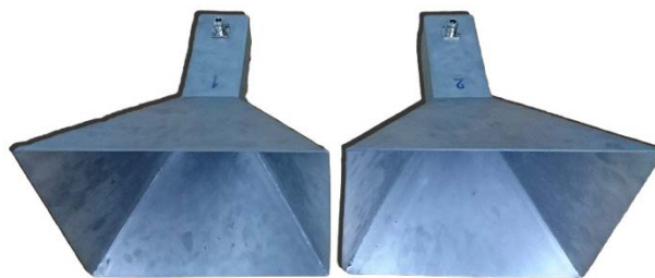
รูปที่ 4.14 สายอากาศปากแตรจากการสร้างจริง
