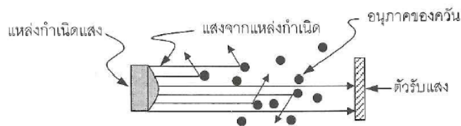
รูปที่ 2.65 การทำงานของอุปกรณ์ตรวจจับควันแบบควันบังแสง
