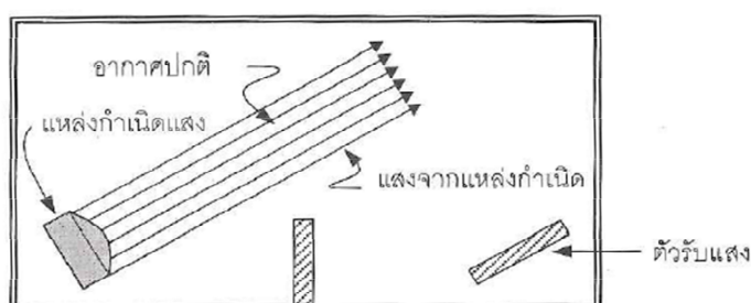
รูปที่ 2.67 การทำงานของอุปกรณ์ตรวจจับควันแบบควันหักเหแสง
