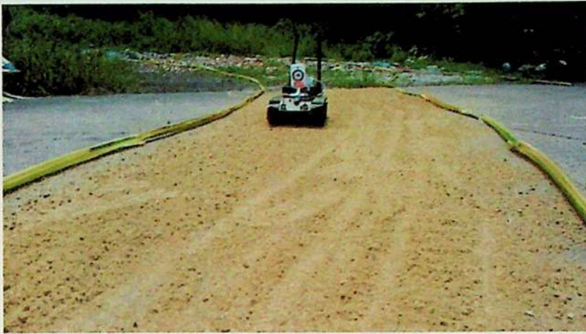
รูปที่ 4.2 การเคลื่อนที่ในทางตรงบนพื้นทราย
