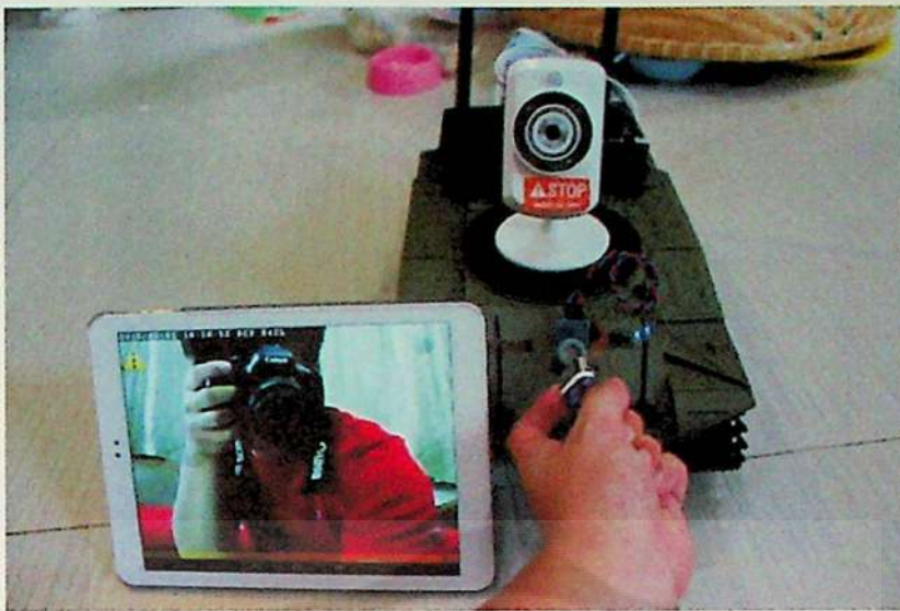
รูปที่ 4.12 ทดสอบ MQ-7 การตรวจจับก๊าซไวไฟ โดยใช้ไฟแช็ค
