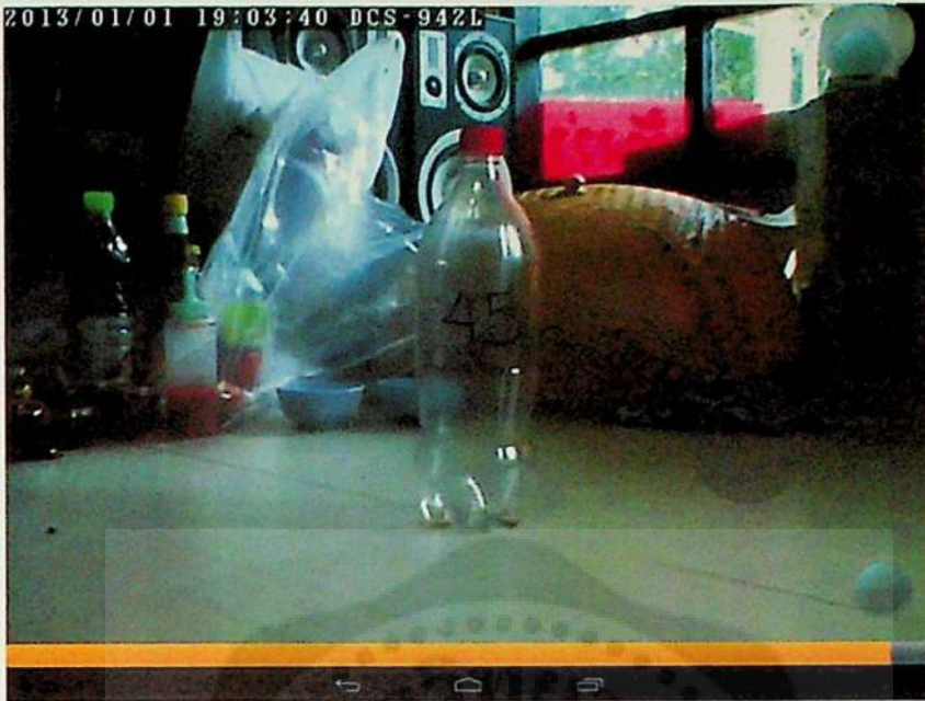
รูปที่ 4.8 การทดสอบการควบคุมการหมุนของกล้อง IP Camera ที่ตำแหน่ง 45 องศา
