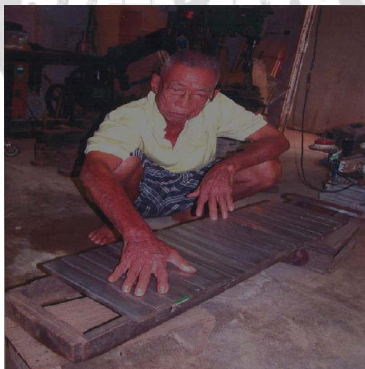
ภาพประกอบ 24 ครูศิรินำแผ่นเหล็กที่ตัดเป็นท่อนๆ สำหรับทำลูกระนาดเหล็กโดยจะนำเหล็กแต่ละท่อนไปไผ่ข้าง ทั้งด้านส่วนหัวและส่วนท้ายทั้ง 2 ด้าน
