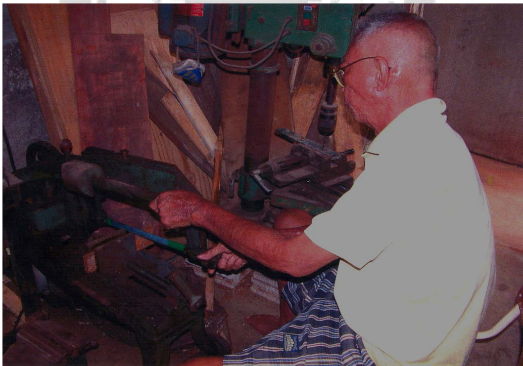
ภาพประกอบ 21 ครูศิริ กำลังควบคุมการทำงานของเครื่องตัดเหล็ก เพื่อนำแผ่นเหล็กที่ตัดเป็นท่อนตามขนาดมาทำเป็นลูกระนาด
