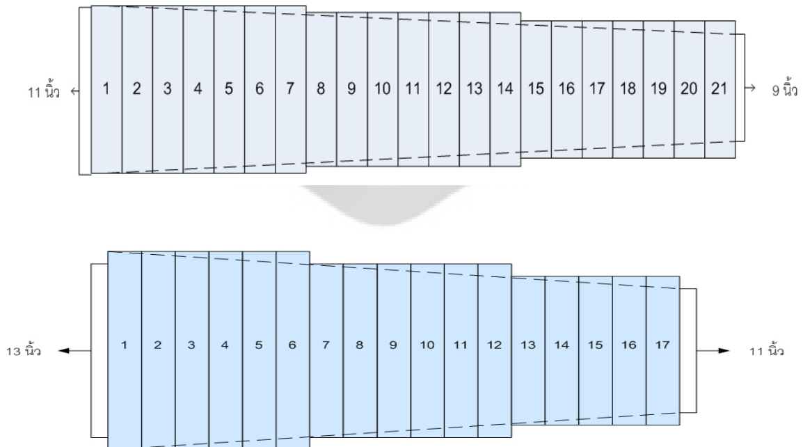
ภาพประกอบ 27 ลูกกระดาษเอกเหล็กที่ทำสัญลักษณ์เพื่อนำไปตัดขอบ
