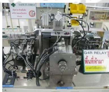
Process Caulking จะทำการจับ ยึดระหว่าง Base และ Case
