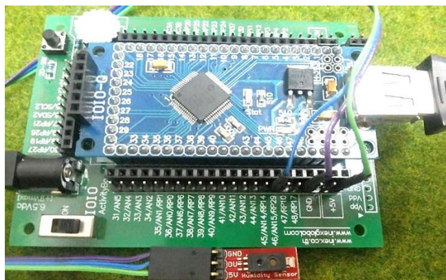
รูปที่ 3.10 การเชื่อมต่อโมดูลHIH4030 เข้ากับบอร์ด IOIO-Q
