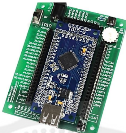
รูปที่ 2.34 บอร์ด IOIO-Q เมื่อติดตั้งลงบนบอร์ด IOIO-Q Activity ที่มา หนังสือ Android กับการเชื่อมต่อวงจรอิเล็กทรอนิกส์
