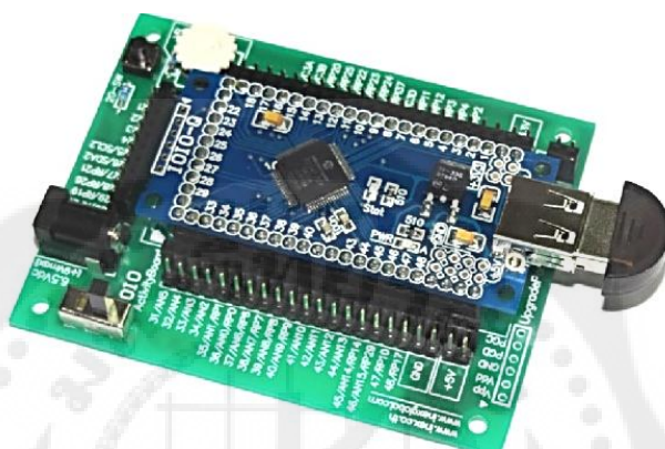
รูปที่ 2.5 IOIO Activity board ที่ติดตั้งบอร์ด IOIO-Q และบลูทูธคองเกิลพร้อมใช้งาน ที่มา http://www.inex.co.th/
