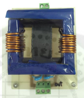
รูปที่ 3.16 วงจรกรองสัญญาณรบกวนแม่เหล็กไฟฟ้าทางสายตัวนำโดยตัวเหนี่ยวนำโมดผลร่วมแบบดั้งเดิมที่มีค่าความเหนี่ยวนำโมดผลร่วมเท่ากับ 0.12 \text{ mH} และมีตัวเก็บประจุเท่ากับ 10 \text{ nF}
