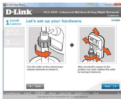
โปรแกรมช่วยอธิบายวิธีการปรับองศาของตัวกล้อง
