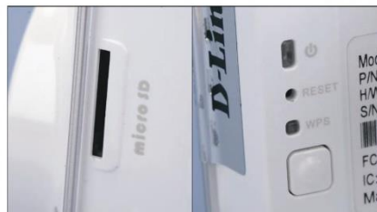
ช่องใส่ microSD card และปุ่ม WPS พร้อมไฟสถานะการทำงาน
